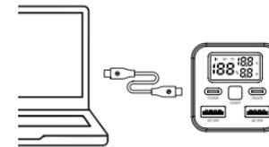
Schließen Sie den PowerPort über den USB C-Port mit dem mitgelieferten USB Typ C- auf USB Typ C-Kabel an Ihren Computer an. Alternativ können Sie den PowerPort auch mit einem USB Typ A- auf USB Typ C-Kabel (nicht im Lieferumfang enthalten) über Ihren Computer laden.
